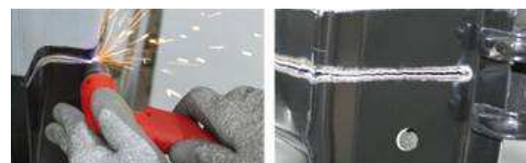
STEEL : 6 mm max ALU : 4 mm max (Speed = 15 cm / min at 20A)
